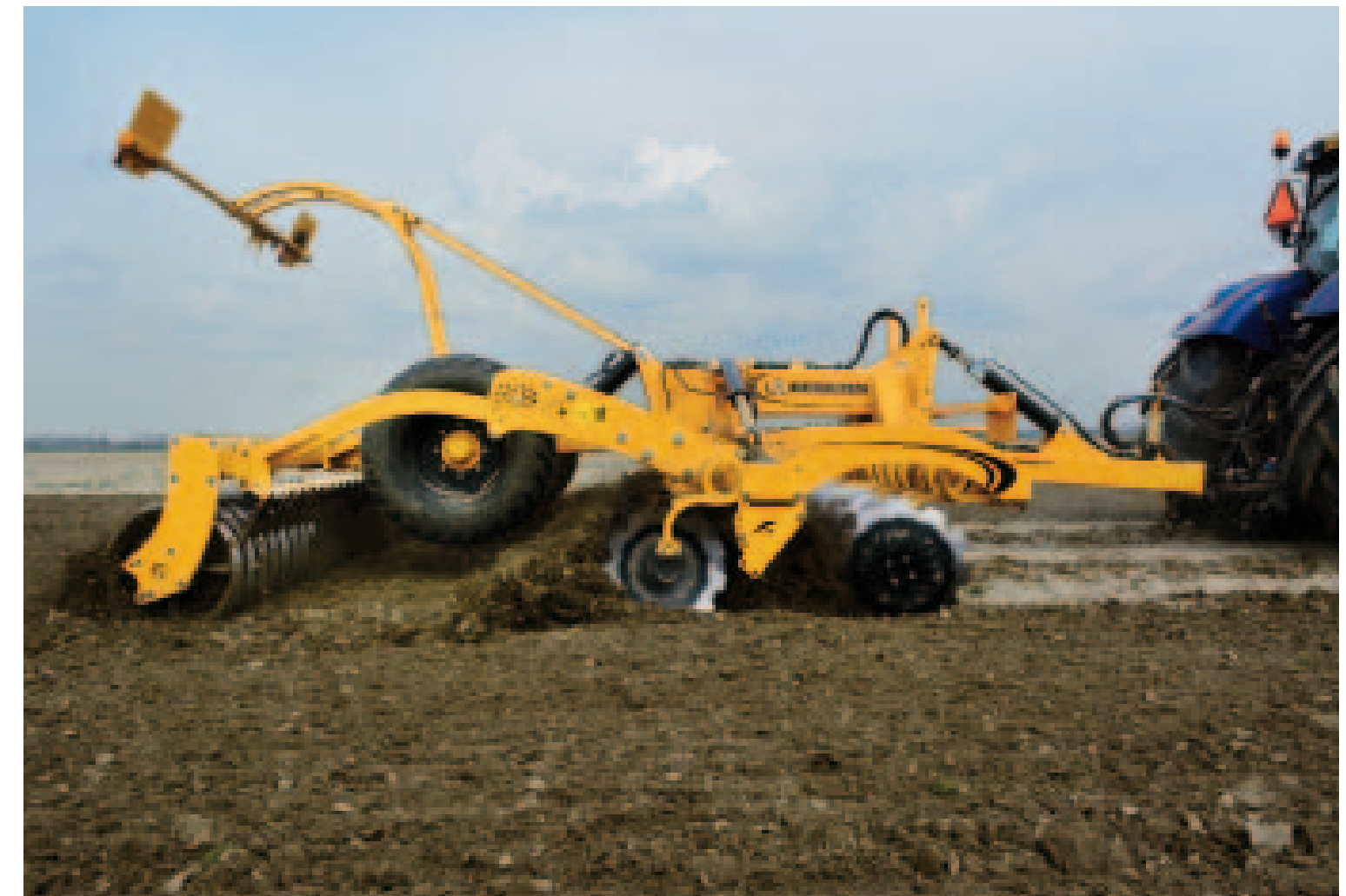
^ Van voor naar achter De Agrisem Disc-O-Mulch Gold hangt in de trekhaak [1]. Met de cilinder op de dissel [2] en met de hoogteverstelling [3] van de wals stel je de werkdiepte van de machine in. De eerste rij schijven [4] werpt de grond tegen het verstelbare kluitenbord [5]. De tweede rij schijven [6] is net als de eerste verend opgehangen. Alleen de lagers van het wielstel en de Spire wals [7] moet je smeren.
