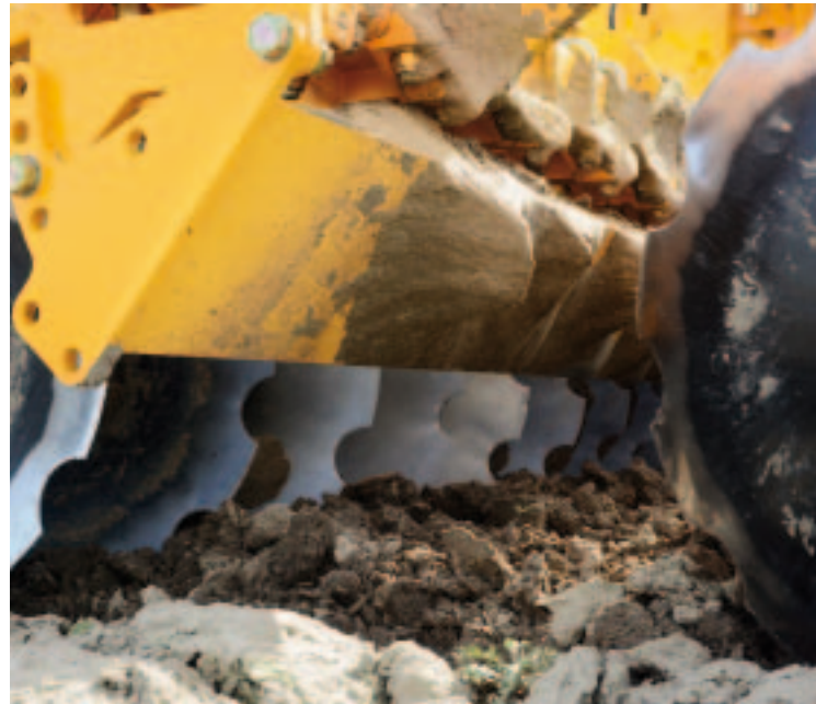
^ Het onkruidbord Achter de eerste rij schijven is een onkruidbord gemonteerd. Het breekt kluiten waardoor het ook onkruidwortels van grond ontdoet. De hoek van het bord en dus de intensiteit is in vier stappen verstelbaar.
