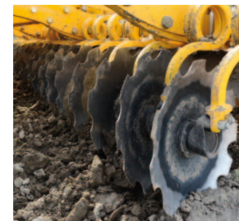
^ De eerste rij schijven Alle schijven van de machine zijn verend opgehangen. Daardoor bewegen de schijven in de breedte, de lengte en de hoogte.
