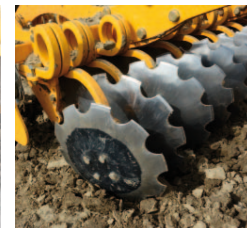
^ De tweede rij schijven Na het kluitenbord is een tweede rij schijven gemonteerd onder een vaste hoek. De buitenste schijf is kleiner dan de rest.
