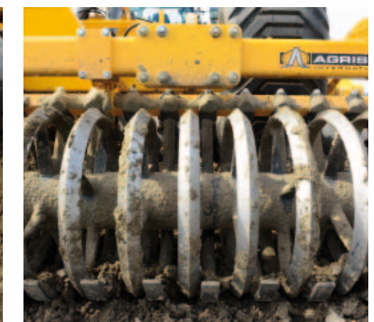
^ Goedkope wals Standaard is op Nederlandse machines de goedkoopste wals gemonteerd. Hij wordt schoongehouden door stalen vingers.
